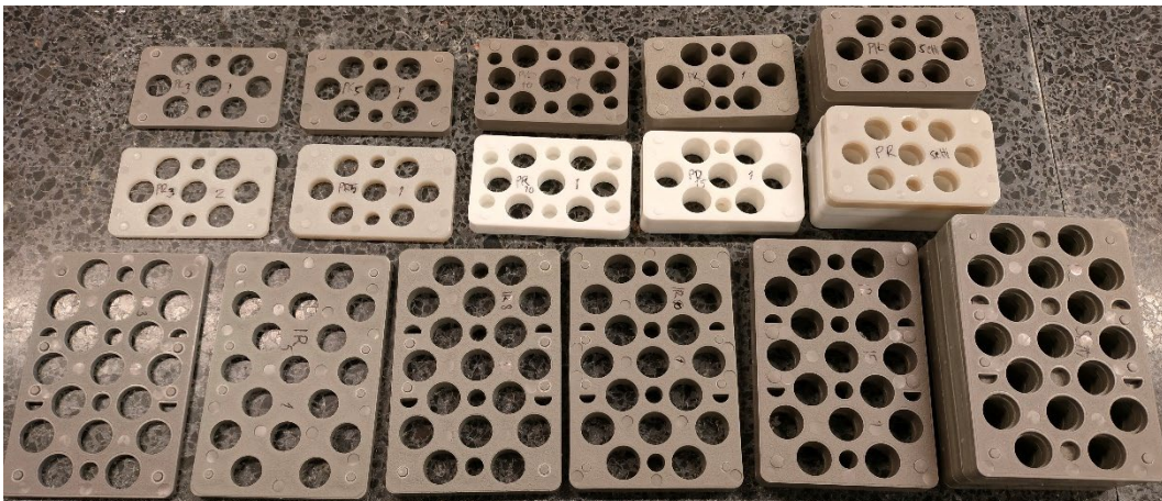
Kuva 1. Yksittäiset asennuspalat ja niput kuormitusten jälkeen, ryhmittäin ylhäältä alaspäin 1, 2 ja 3.
