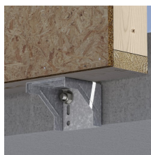
Asennus puuelementin pohjaan
