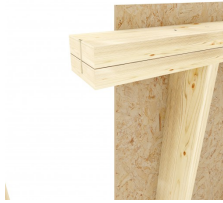
Fixation de ceinture périphérique sur la lisse haute
